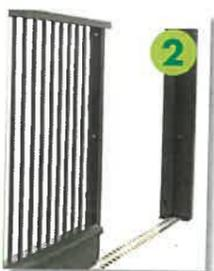
**Le poteau de réception** intègre les barrages photoélectriques. Les câblages électriques passent dans la gaine métallique incorporée aux rails de guidage. Le poteau de réception peut aussi recevoir des options telles que le contact pompier ou PTT pour permettre une manœuvre plus aisée par ces accessoires.
