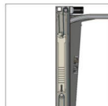
**La porte DBM 08 CPR est équipée d'un contrepoids** avec triangulation qui garantit un bon équilibrage et s'adapte parfaitement aux exigences de sécurité de la porte. Afin de garantir une grande fiabilité de fonctionnement, nous avons éliminé l'utilisation des câbles et sangles. L'entraînement et la suspension du tablier se font uniquement par **des chaînes 12.7** dont le coefficient de sécurité à la rupture est supérieur à 20.
