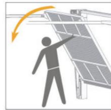
En position fermée, la porte est verrouillée par la motorisation. En cas de panne de courant, la motorisation est débrayable par l'intermédiaire d'un contact situé sur le dormant moteur. **Une manoeuvre manuelle facile et rapide** de la porte est alors possible en agissant directement sur le tablier.
