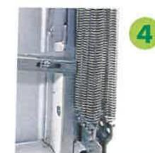
L'équilibrage est effectué par **ressorts multiples** qui permettent un réglage souple de la porte.
