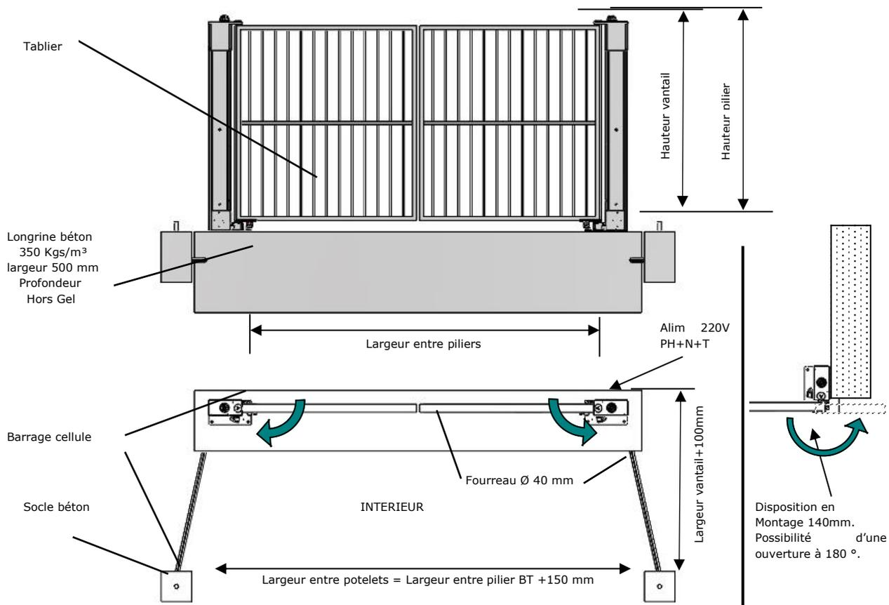
Limitation dimensionnelle : Largeur maximale vantail:1750 mm Hauteur maximale 2500mm poids maximum 100kgs/vantail.
